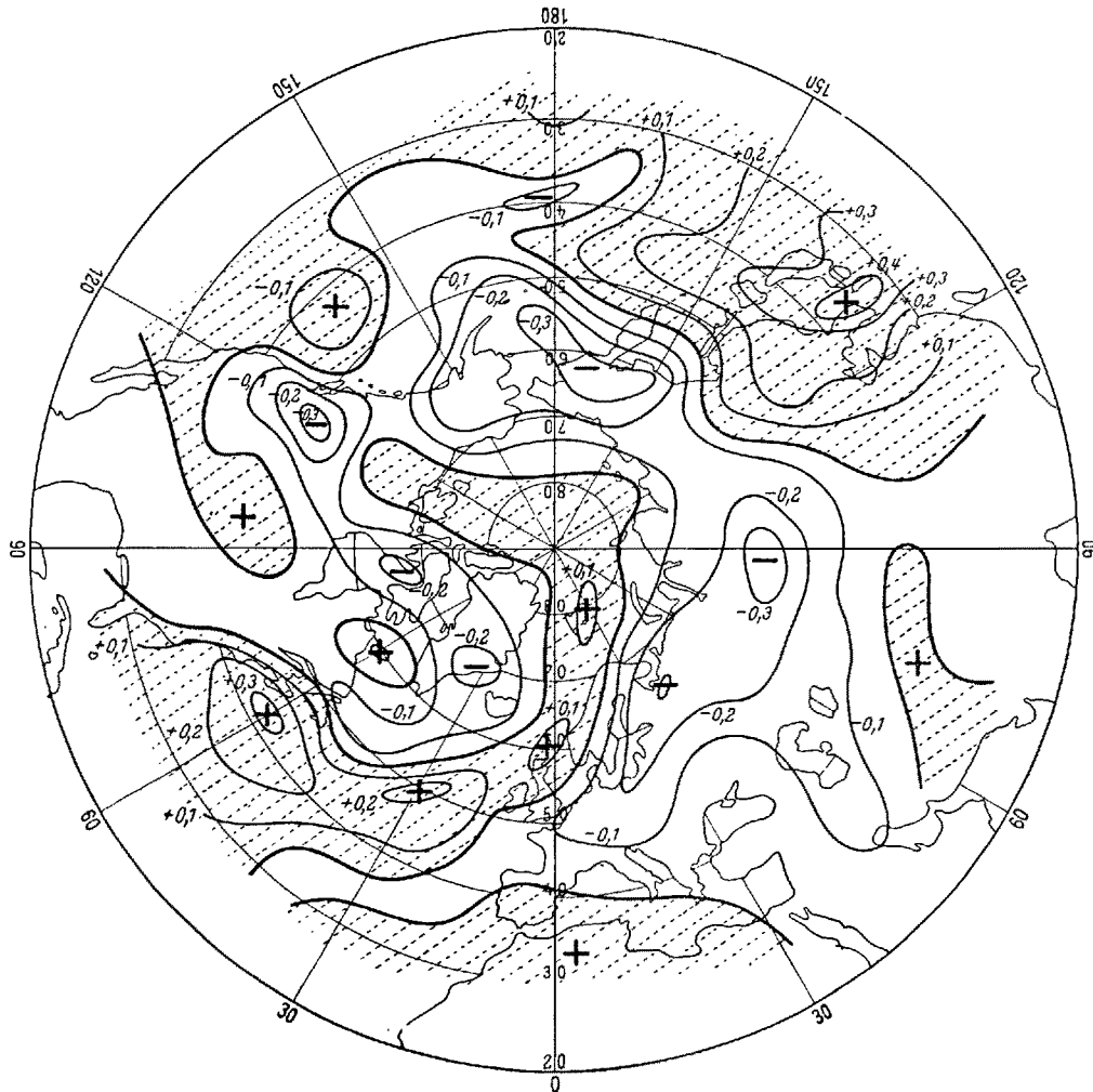
Abb. 4. Mittlere Wärmeaufnahme und -abgabe der Luft zwischen 0 und 3 km im Januar, Zahlenwerte in \text{cal/cm}^2\text{min}^{-1} ( 3 \text{ km}^{-1} ), entsprechend 10^\circ/\text{Tag} . Berechnet aus den Temperaturänderungen bei Advektion. Gebiete mit Erwärmung schraffiert, nach MÖLLER.
